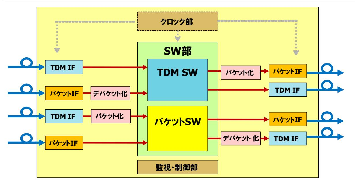
モデルⅢ:TDM信号を全てパケット化し、パケットスイッチにてスイッチングする
