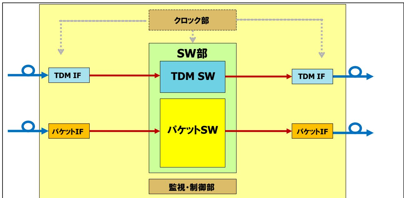
モデルⅡ:TDM信号を一部パケット化して、パケットスイッチにてスイッチング、
