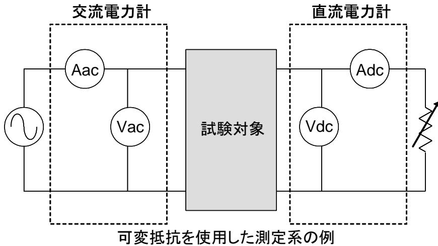
可変抵抗を使用して、銘板電流の100%、75%、50%、25%となった時のそれぞれの変換効率  $\eta_{100}$ 、 $\eta_{75}$ 、 $\eta_{50}$ 、 $\eta_{25}$ を測定し、その平均値  $\eta$ を求める。
