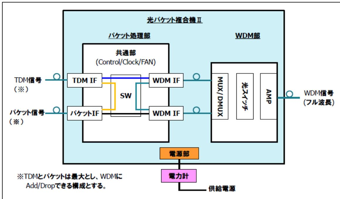
【 $P_{idle}$ 測定時の構成例(最小実装の最小パス構成)】
