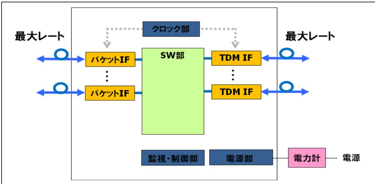
【P<sub>idle</sub>測定時の構成例(最小実装の最小パス構成)】
